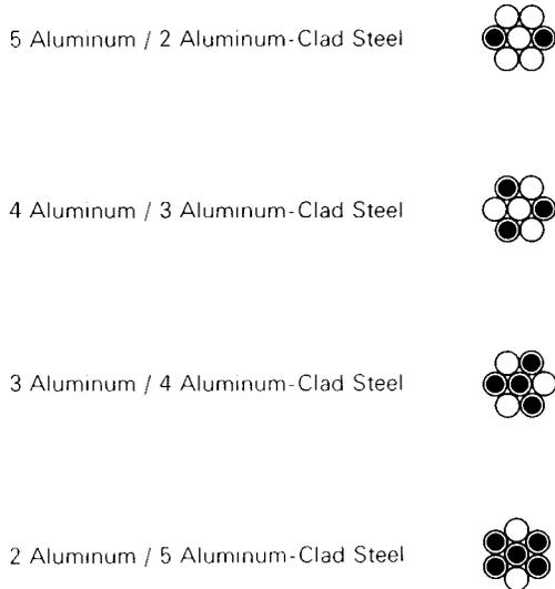
○ ALUMINUM      ● ALUMINUM-CLAD STEEL
